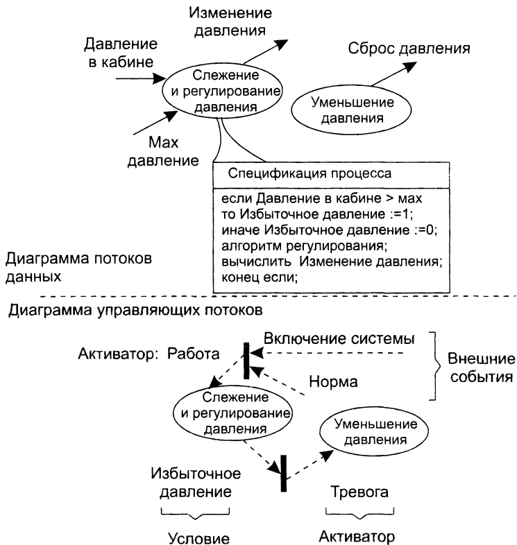
Рис. 5.9. Модель системы регулирования давления космического корабля
