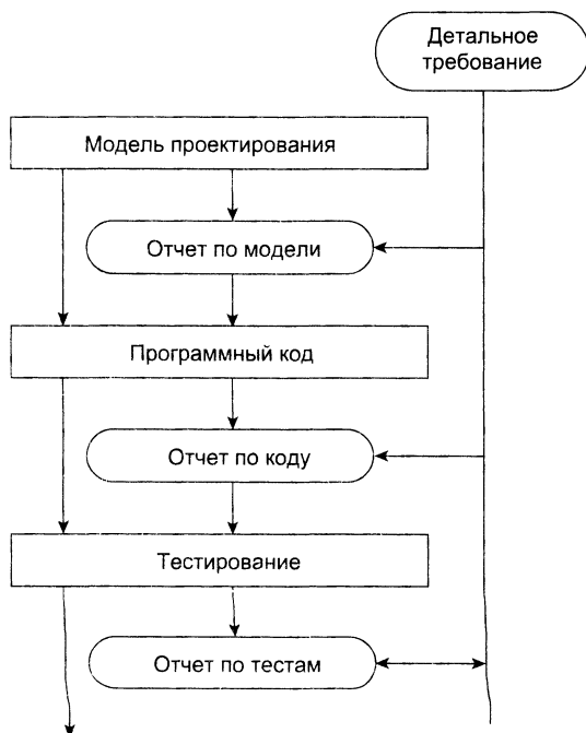
Рис. 4.2. Прослеживание детального требования (стрелки показывают связи прослеживания)
