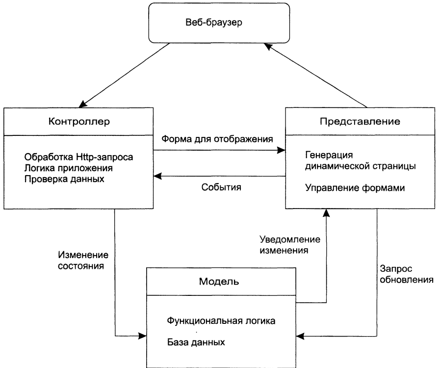
Рис. 6.4. Архитектура веб-системы на основе паттерна модель-представление-контроллер
