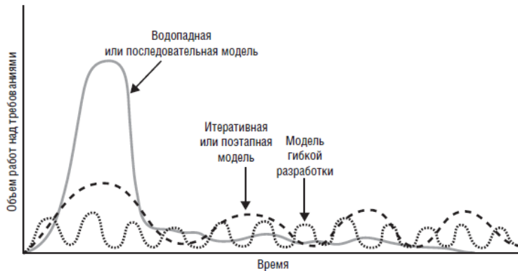
Рис. 3. Распределение работ с требованиями на протяжении жизненного цикла проекта в разных моделях разработки
