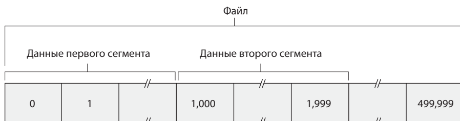
Рис. 3.30. Разделение файла данных на ТСР-сегменты
