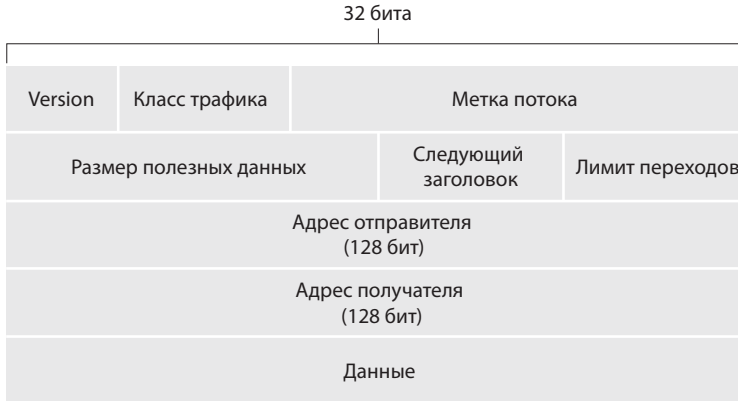
Рис. 4.24. Формат дейтаграммы IPv6
