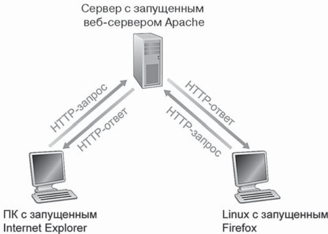
Рис. 2.6. Процедура запросов и ответов HTTP
