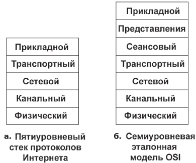
Рис. 1.23. Стек протоколов Интернета (а) и эталонная модель OSI (б)
