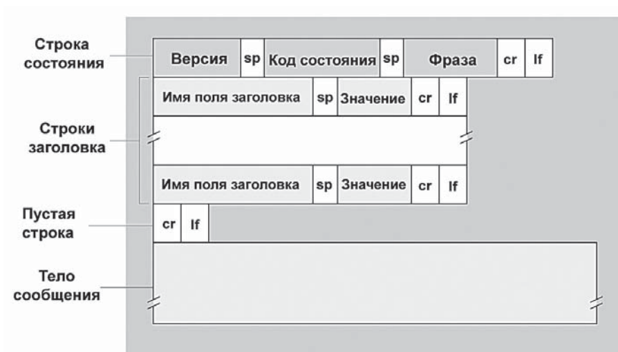
Рис. 2.9. Общий формат сообщения-ответа протокола HTTP
