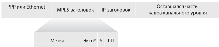
Рис. 5.28. MPLS-заголовок размещен между заголовками канального и сетевого уровней
