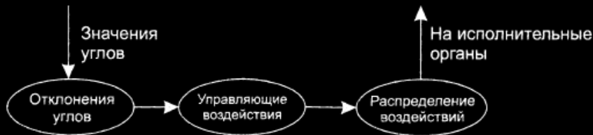
Рис. 6.10. Архитектура системы угловой стабилизации ЛА
