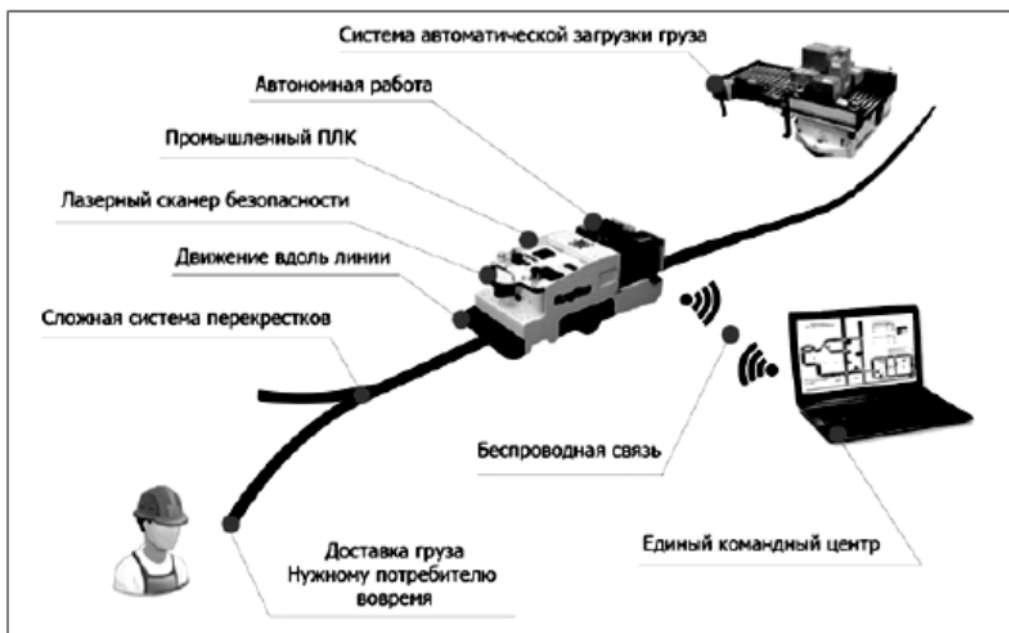
Рис. 8 – Принцип работы автоматизированной транспортной системы.
