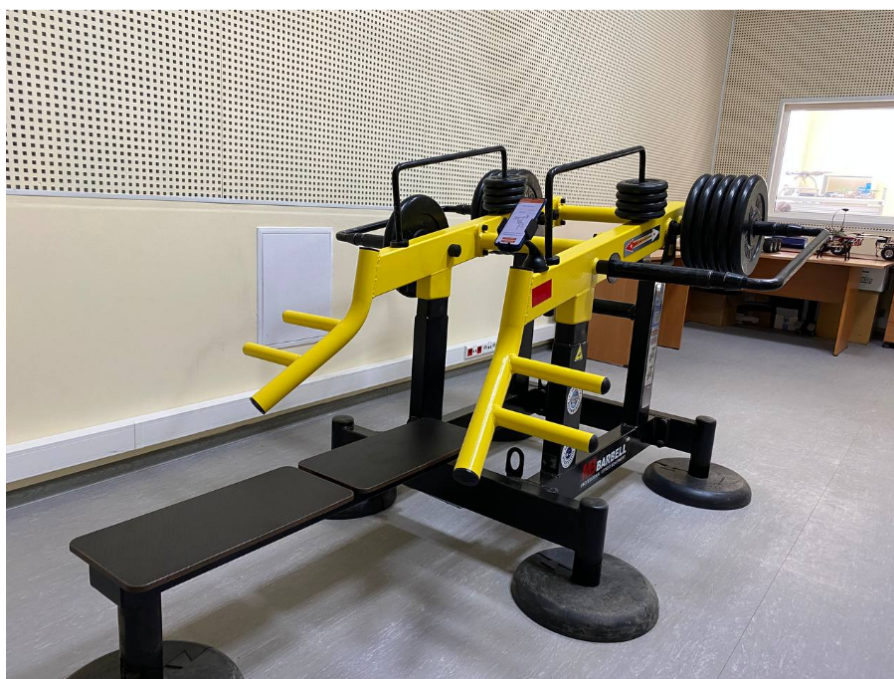
Рис. 4: Используемый тренажер для проведения экспериментов. Фиксатор для смартфона установлен с правой стороны на подвижной раме.
